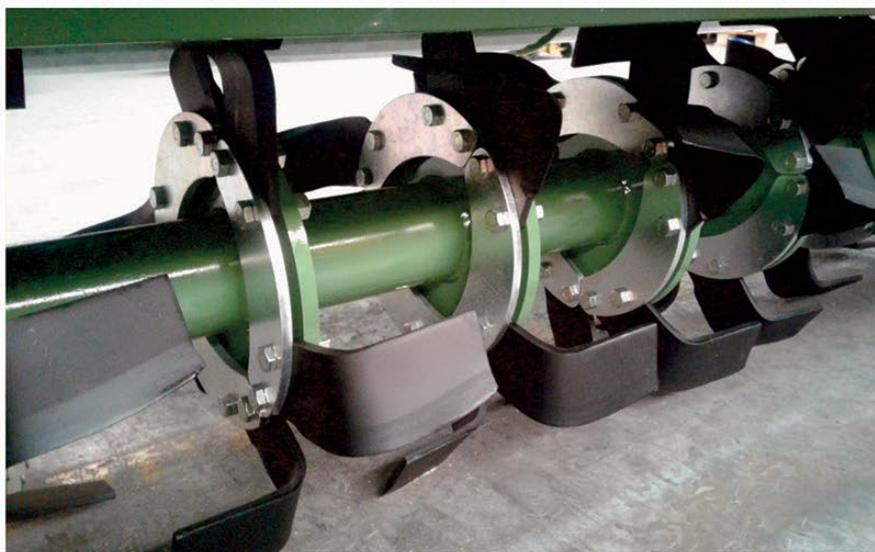
trinciatura delle erbe infestanti avviene in modo netto e preciso, viene colpita la radice, in modo da evitare che esse possano ripresentarsi.
