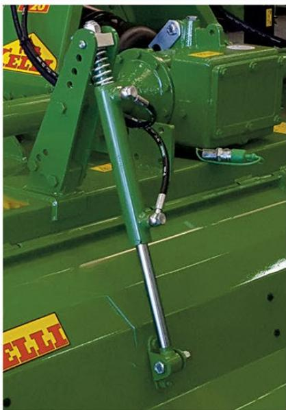
Il cofano posteriore ad apertura maggiorata è stato studiato appositamente per evitare che i residui lavorati dalla fresa non vadano ad urtarlo, mantenendo così intatta la materia organica e riducendo il rischio di compattamento.
